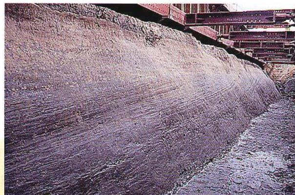
写真5 砂州の断面写真
